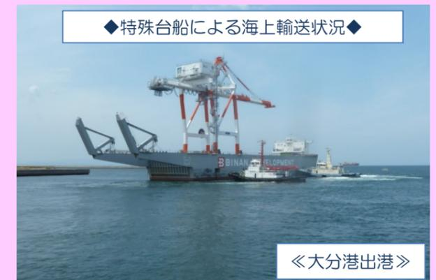
クレーンは三井造船(株)大分事業所から玉島ハーバーアイランドまでを海上輸送しました。日本で1船だけの特殊台船“天佑”に積載し、曳船が牽引して輸送距離約132マイル(約212km)を24時間かけて運びました。
