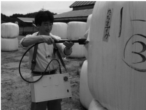
写真1 可搬型 NIRS 装置試作機によるイネ WCS の成分分析
