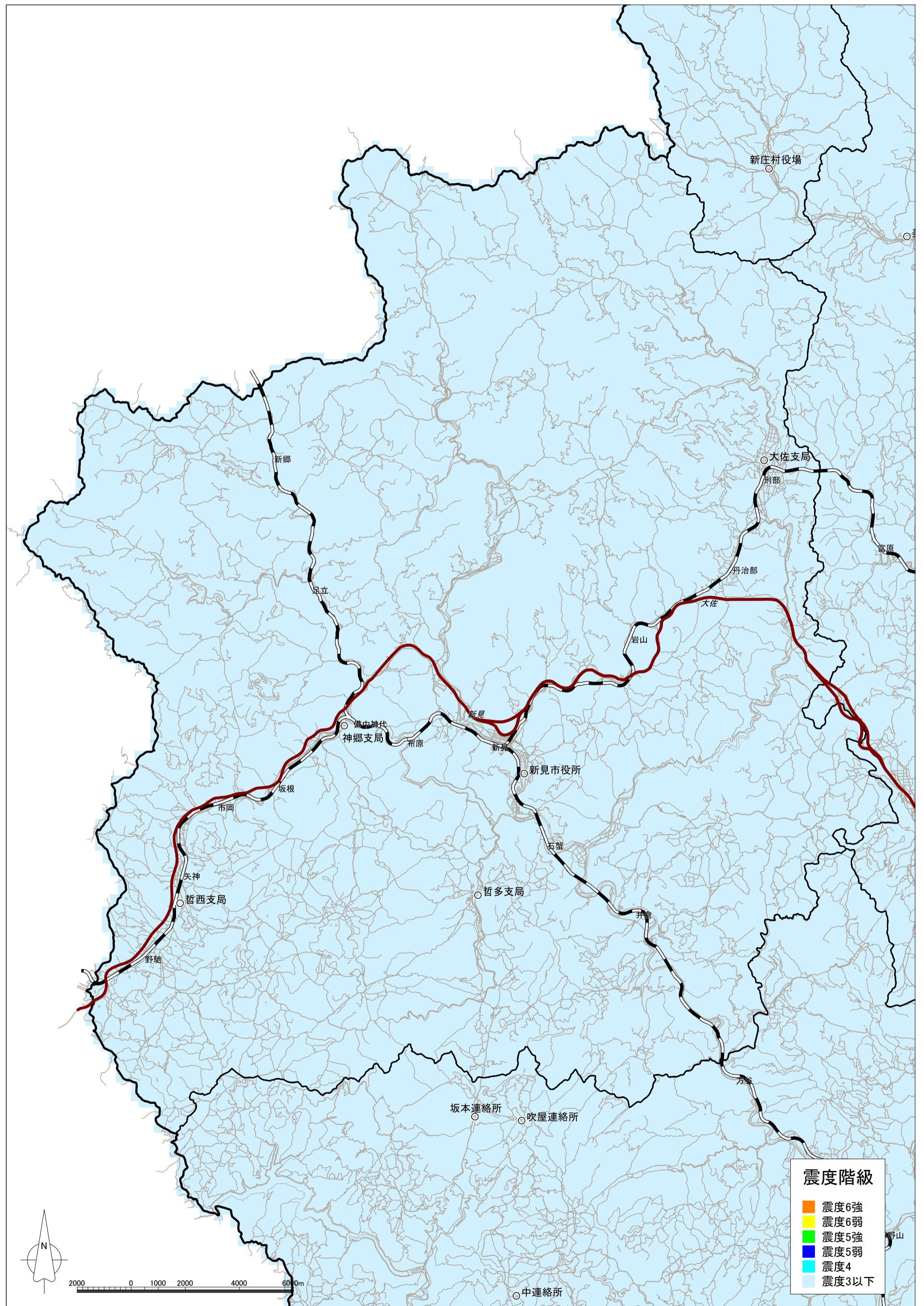
中央構造線断層帯(讃岐山脈南縁-石鎚山脈北縁東部)の地震による液状化危険度分布図【岡山県想定】新見市
