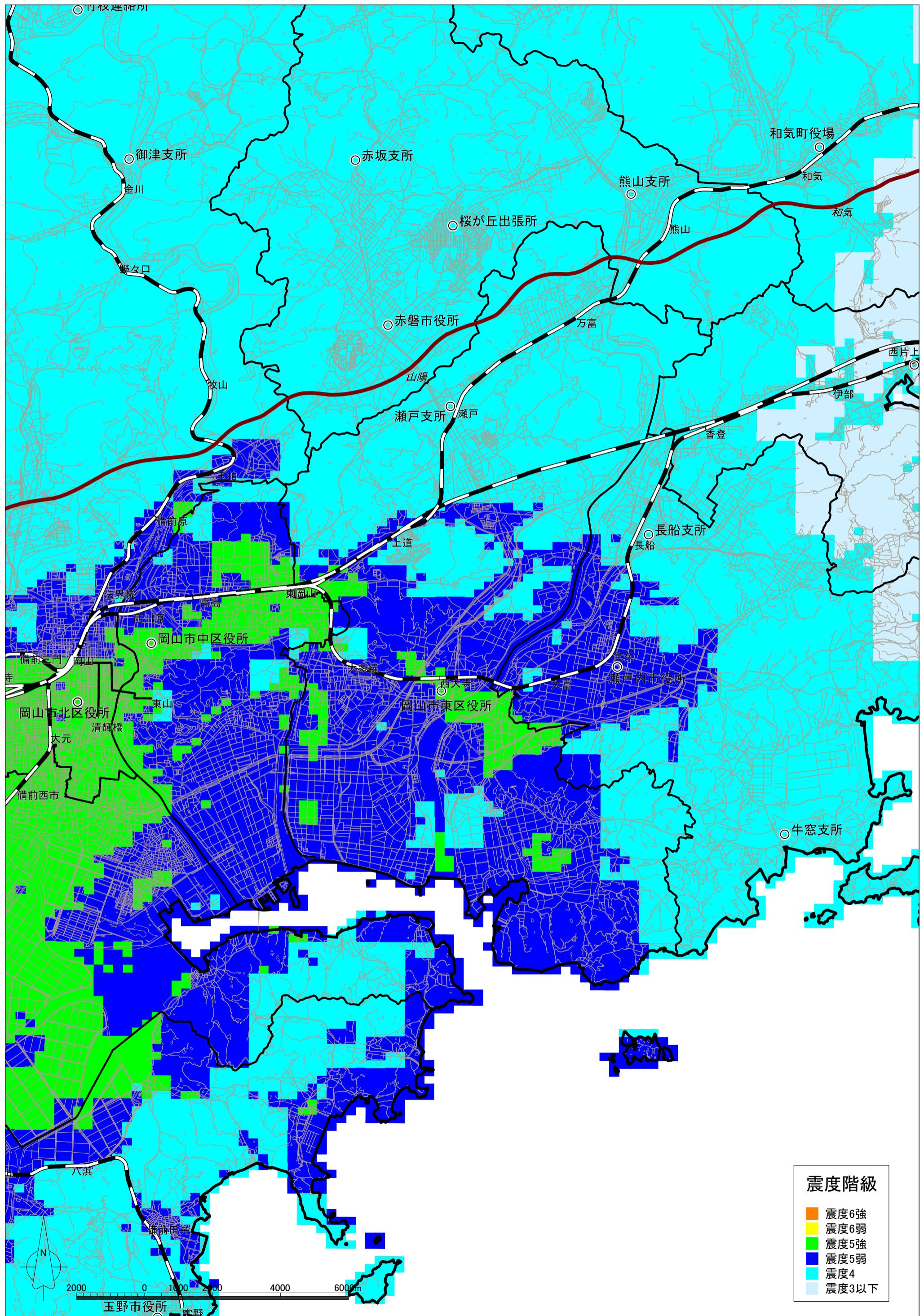
長者ヶ原断層-芳井断層の地震による液状化危険度分布図【岡山県想定】 岡山市東区
