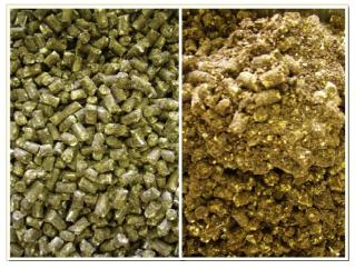
図2 正常なペレット(左)と膨化・固結したペレット(右)
