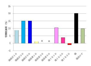
図3-1 造粒時の容積削減率(鶏)
