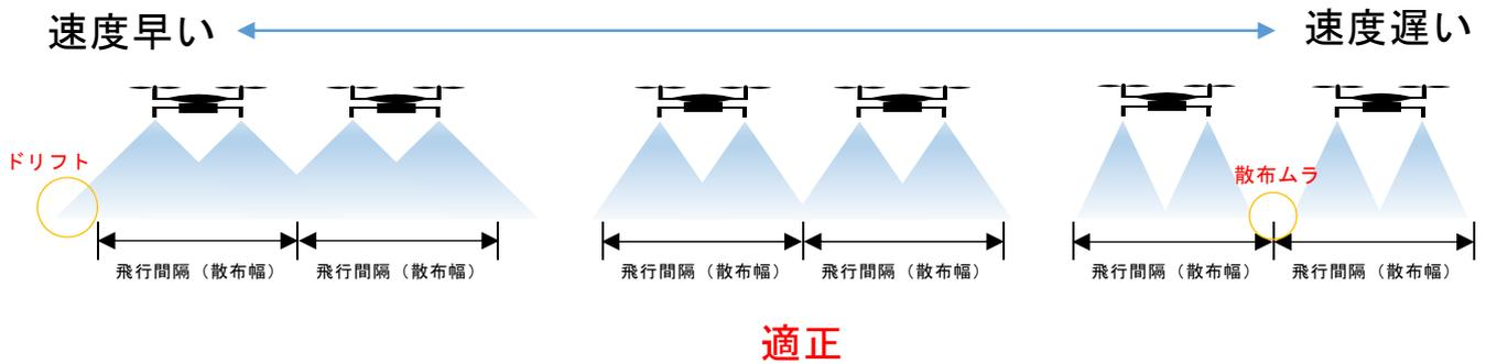
○飛行高度の違い（飛行速度及び飛行間隔が一定の場合）
