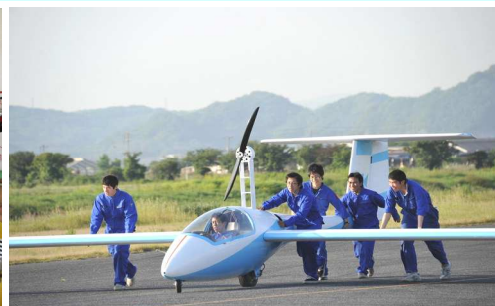
初飛行に挑戦 エアロMECIA 世界初のトライブリッド有人小型飛行機
