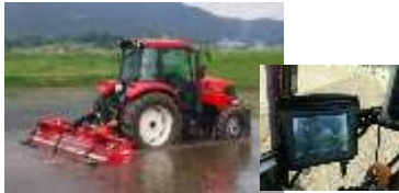
自動操舵トラクタ 作業精度の向上による時間削減
