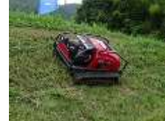
リモコン式自走草刈機 作業時間削減、軽労化
