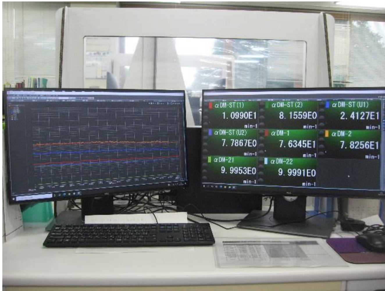
建屋から放出される排気の監視画面
