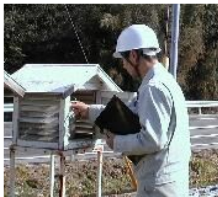
百様箱の中に放射線の測定器を設置した定点測定
