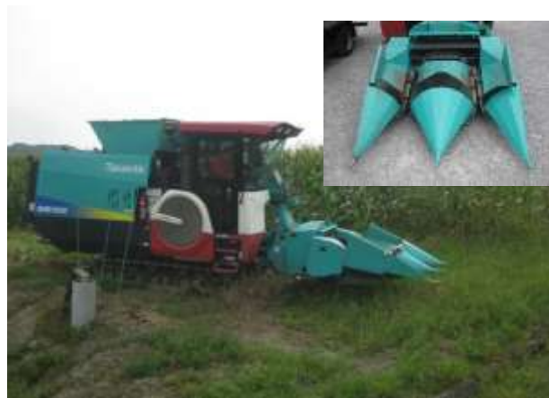
図 1 スナッパヘッドを装着した汎用型飼料収穫機
