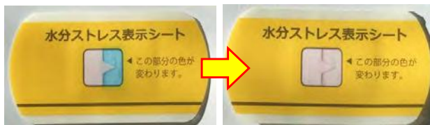
図2-4-6 水分ストレス表示シートの外観 (左:変色前、右:変色後)
