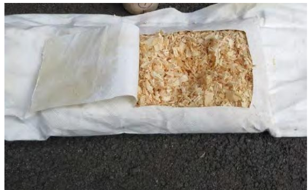
図3-3-7 新規保護材の3年使用後の充填物 (プレーナー屑) の様子
