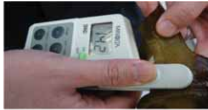
図8. 葉緑素計(コニカミノルタ製SPAD-502)を用いてワカメ藻体のSPAD値を計測。
