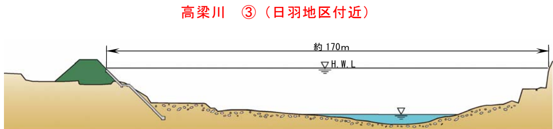
図-9 高梁川本川の代表断面図 (宍粟地区から槻地区)
