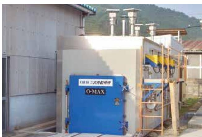
高品質な木造住宅を提供するために新しい乾燥技術を開発しています。(熱風減圧乾燥装置)
