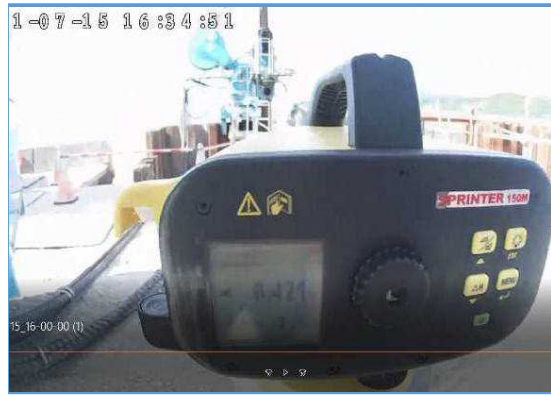
【電子レベルによる基準高の計測】
