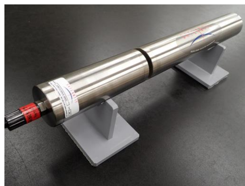
図 1 4 現場に設置した硝酸塩センサー (ISUS V3)
