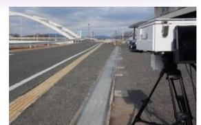
可搬式速度違反自動取締装置を活用した取締り
