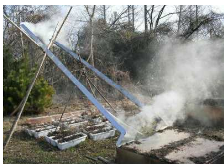
分解・組立式木竹酢採取装置
