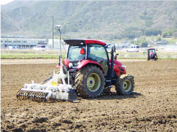
ほ場を均平化するGPSレベラー
