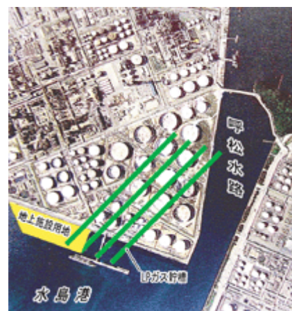
【写真説明】空から見たLPGガス備蓄・倉敷基地の建設地 （4本線が地下貯蔵タンク） <山陽新聞社提供>
