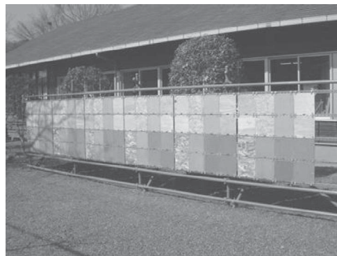
木質パネル屋外暴露試験の状況
