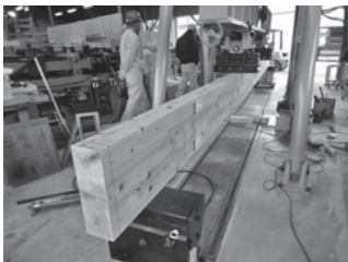
重ね梁の曲げ試験
