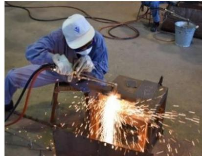
【ガス溶接、溶断実習】
