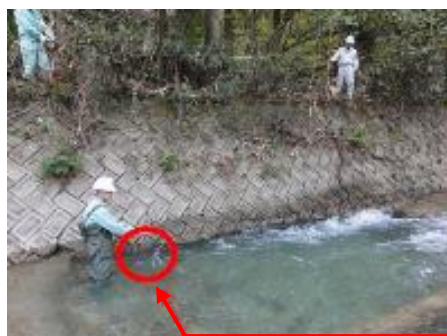
ポールを差し込み、洗堀を確認する
