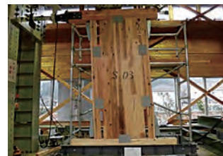
CLT 壁面の強度試験
