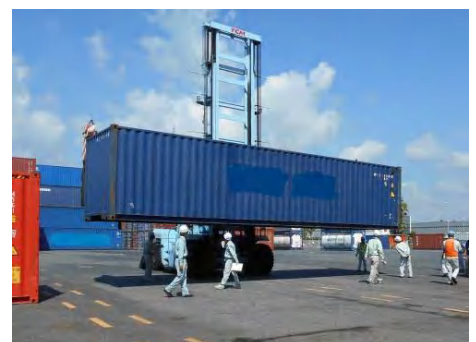
〔※コンテナ床下点検の様子〕
