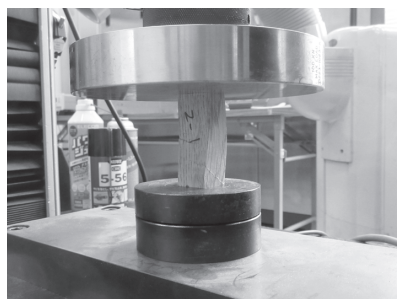
図2 縦圧縮強度試験の状況
