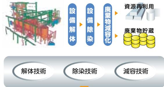
核燃料施設廃止措置に必要な様々な要素技術の総合化と体系化を図り、放射性廃棄物発生量の低減と解体コストの最適化を図るシステムを構築
