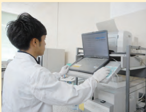
空間ガンマ線線量率を測定する蛍光ガラス線量計（RPLD素子）の測定
