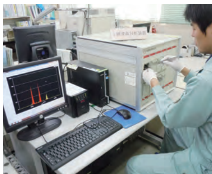
ウランを測定するアルファ線スペクトロメータ
