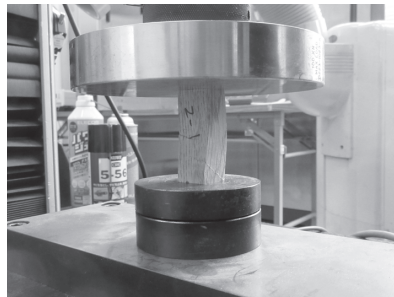
図2 縦圧縮強度試験の状況
