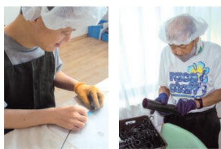
配線部品の組み立て ゴム部品のバリ取り
