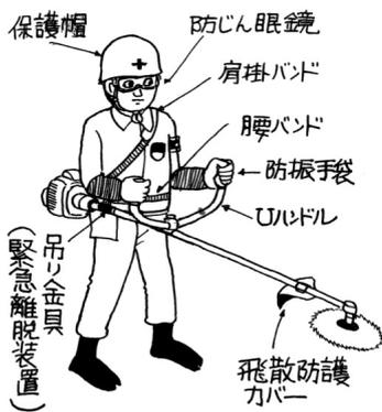
林業では傾斜地で使用することが多いので、作業中に転倒しても体に刈刃が接触しにくい肩掛式、
