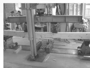
強度試験機による木材性能試験
