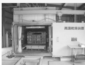
人工乾燥装置による木材乾燥
