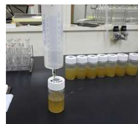
図3 発生ガスの採取
