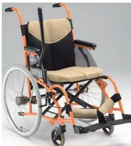
駆動レバーを進みたい方向に倒して戻す操作を繰り返すだけで、車椅子を前後左右に動かすことができる。ハンドリムに比較して操作は容易であるが、レバー操作に力が必要である。屋内など平坦な場所以外では操作が困難である。
