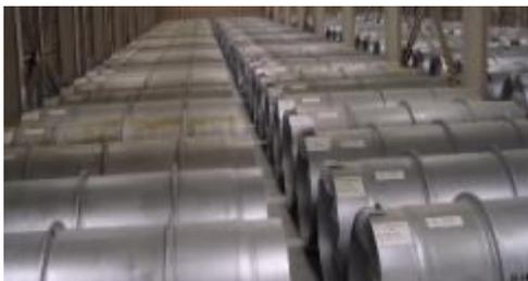
六フッ化ウランを収納した鋼鉄製の容器
