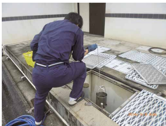
(排水水の行政検査 放流槽での採水)
