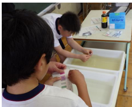
パックテストを使った水質検査
